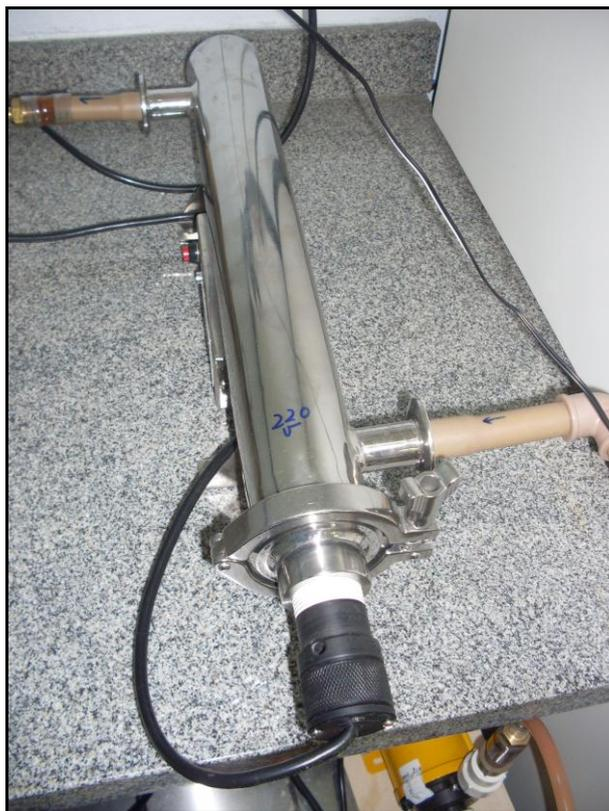
**Figura 5** – Reator tubular para o tratamento fotoquímico.
