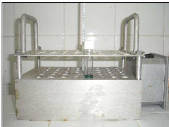
**Figura 8** - Bloco digestor utilizado na análise de DQO.
