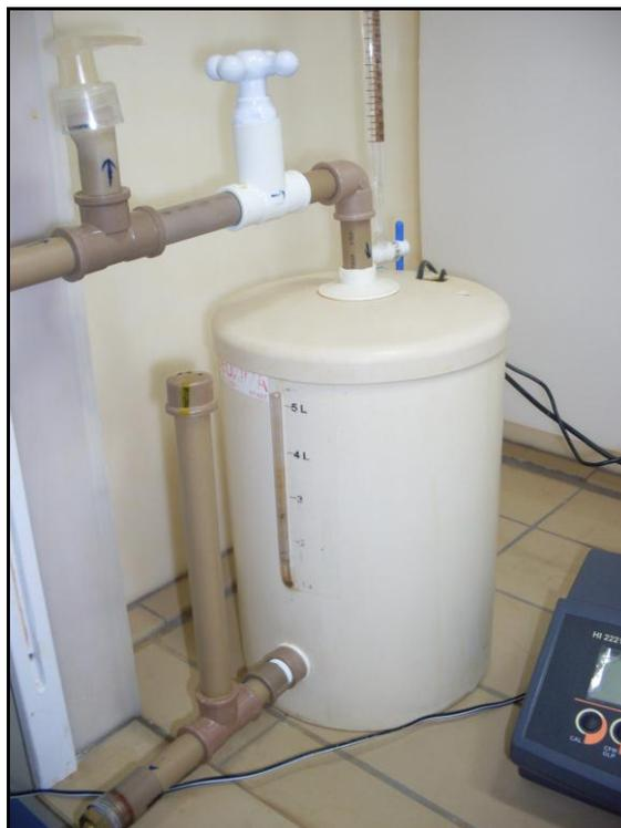
**Figura 6** – Reservatório do Efluente utilizado no processo foto-Fenton.
