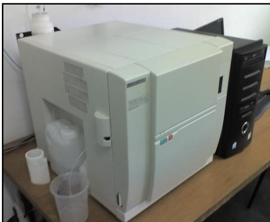
**Figura 9** – Analisador de carbono orgânico total da Shimadzu, modelo TOC-VCPH.
