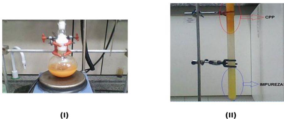
Figura 23 - Sistemas utilizados na síntese (I) e na purificação (II) do CPP.
