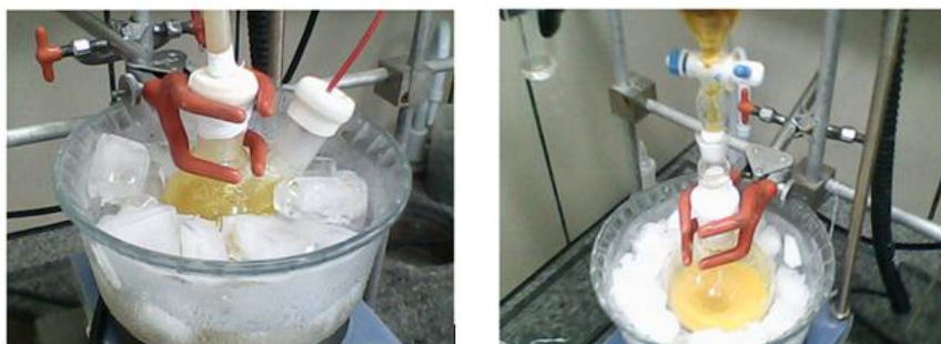
Figura 21 - Sistemas utilizados na síntese do bis(propilsulfaniltiocarbonil)ditiol.
