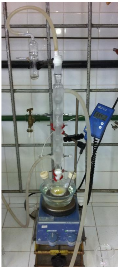
Figura 28 - Sistema utilizado nas polimerizações RAFT em emulsão “ ab-initio ”.
