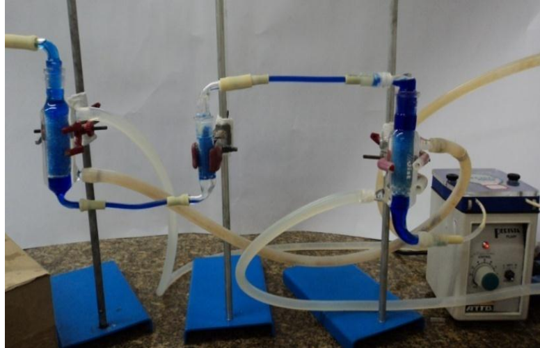
Figura 4.1. Ilustração do sistema durante o teste traçador demonstrando a distribuição do corante nos reator PBR duplo estágio e na coluna extratora de glicerol
