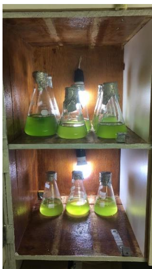
Figura 10 - Banco de células da microalga Chlorella minutissima no interior do cepário do Laboratório de Engenharia de Microalgas da Escola de Engenharia de Lorena
