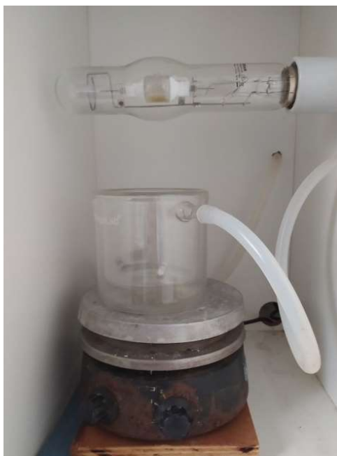
Figura 11- Exemplo de reator montado para funcionamento com luz visível.
