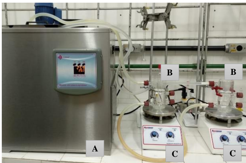
Figura 4.3 – Aparato experimental para o ELL.
