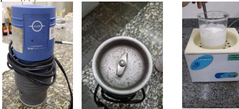
Figura 19 – Equipamentos utilizados no preparo do material fotocatalítico. (a) moinho IKA a11 Basic; (b) moinho (vista em planta); (c) ultrassom
