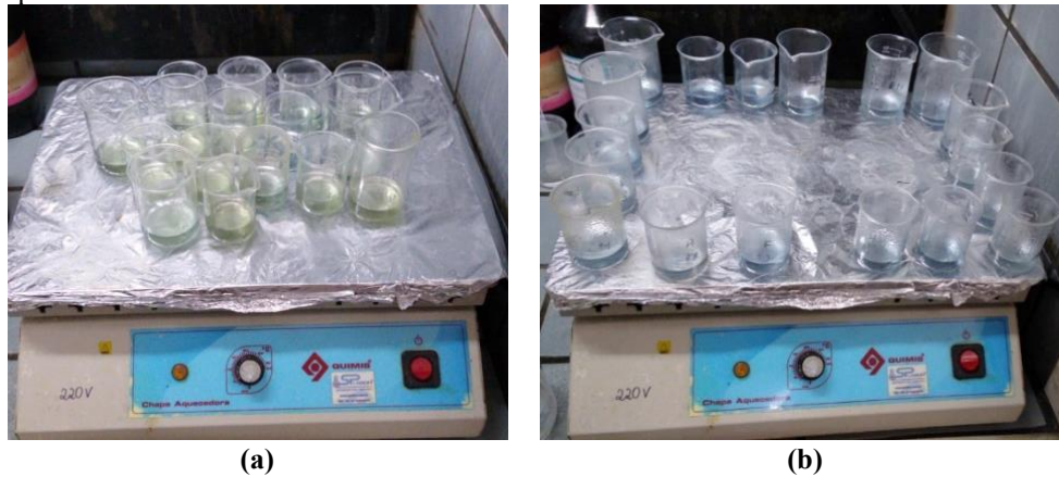
Figura 30 – Etapa de digestão das amostras por aquecimento em uma chapa aquecedora. (a) início do processo. (b) final do processo.
