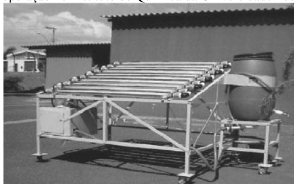
Figura 13 – Reator CPC em operação no Instituto de Química da Universidade Federal de Uberlândia.
