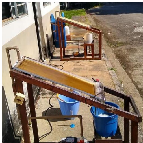
Figura 25 – Layout de um procedimento experimental referente à etapa de tratamento do chorume por fotocatalise heterogênea solar.
