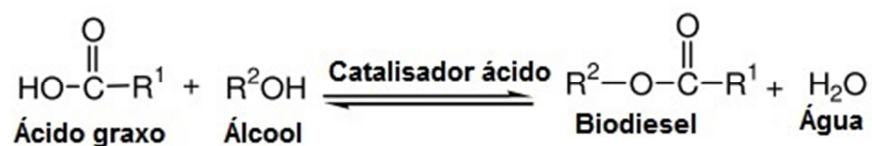
Figura 2.8- Reação de esterificação para formação do biodiesel.
