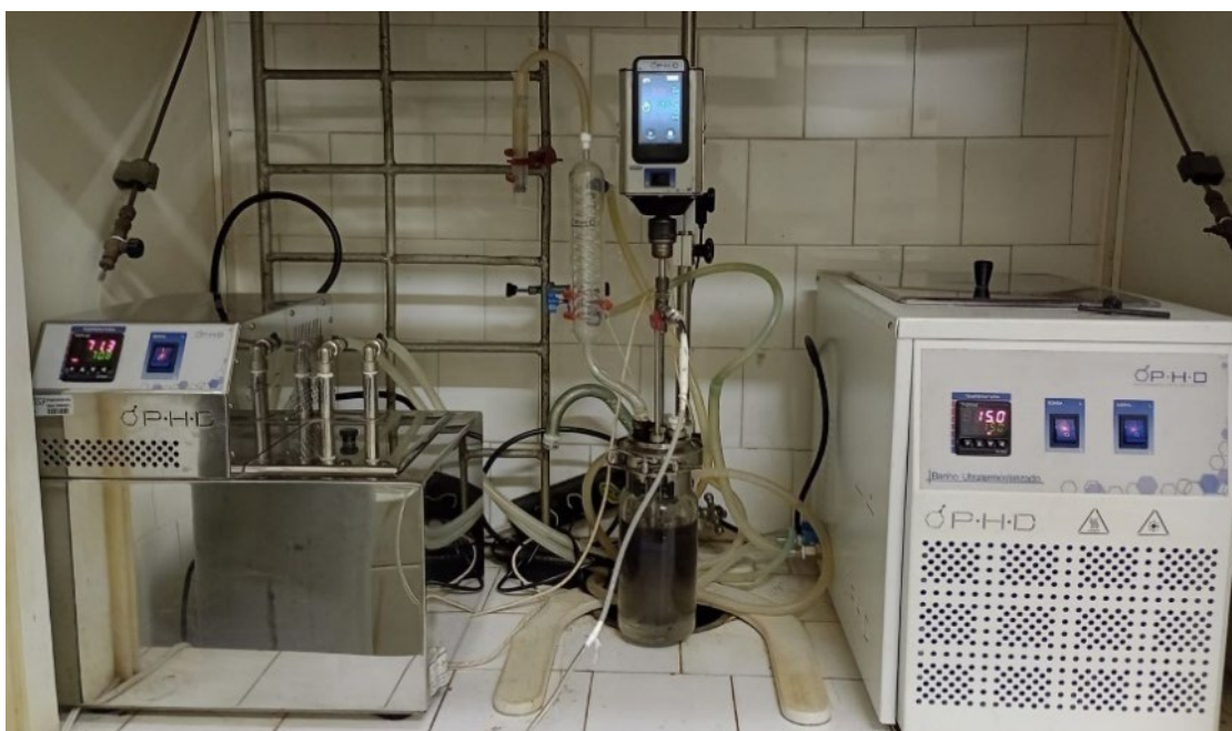
Figura 6 - Sistema experimental utilizado na síntese dos suportes poliméricos.
