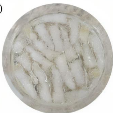
Figura 27 - (A) Aspecto dos scaffolds G durante a lavagem com hidróxido de sódio e (B) Aspectos dos scaffolds G após a lavagem com boro-hidreto de sódio
