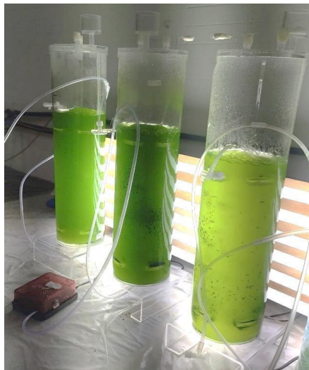
Figura 7 - Fotobiorreatores utilizados no cultivo, operando no laboratório de engenharia de microalgas (DEQUI - USP).
