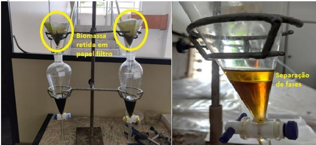
Figura 13 - Filtração da biomassa e separação de fases.
