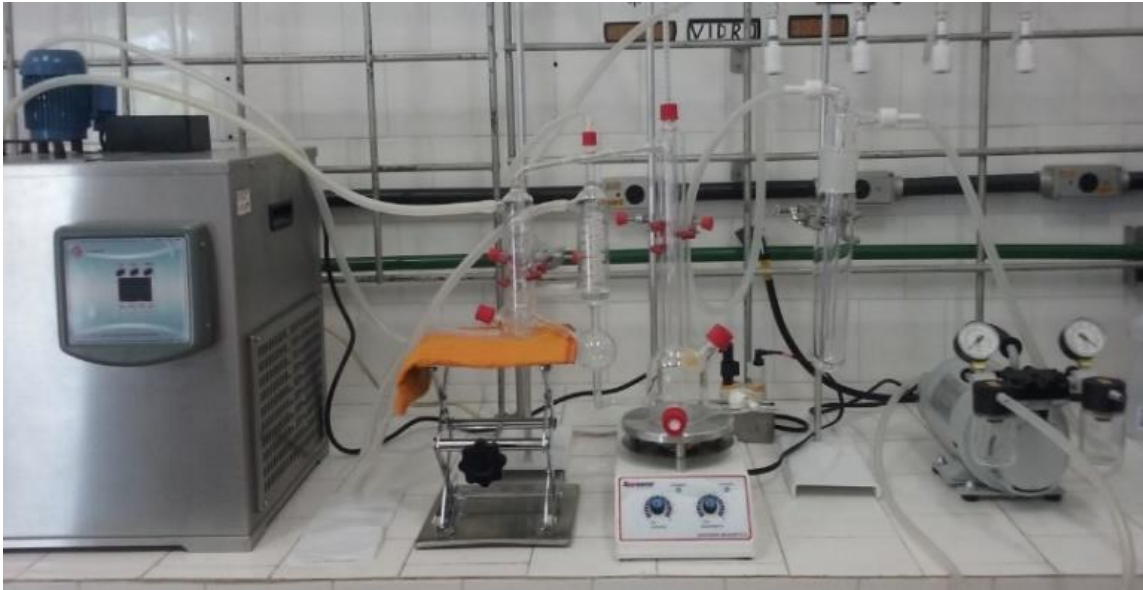
Figura C.1 – Fotografia do equipamento de equilíbrio líquido-vapor
