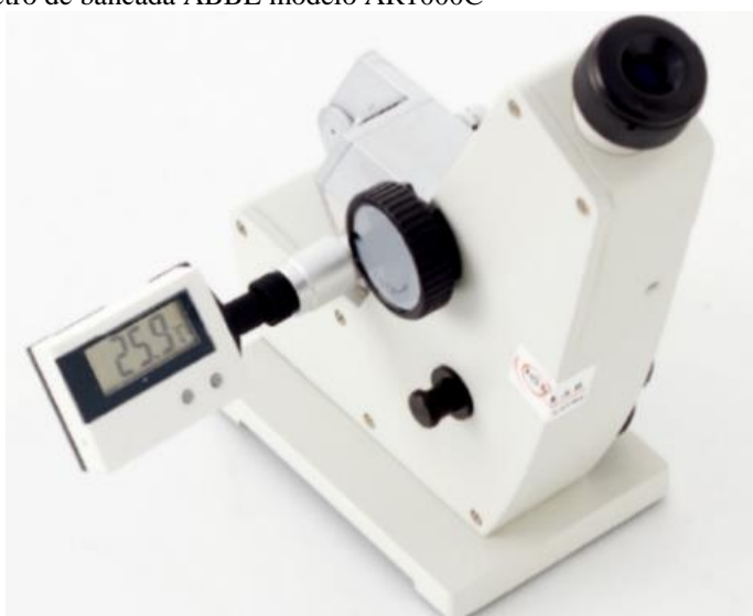
Figura 12 – Refratômetro de bancada ABBE modelo AR1000C
