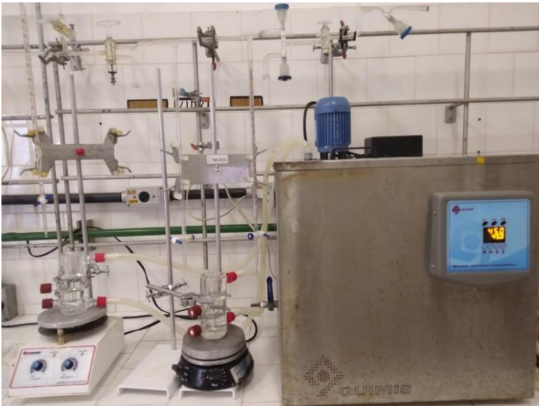
Figura C.2 – Fotografia do equipamento de equilíbrio líquido-líquido
