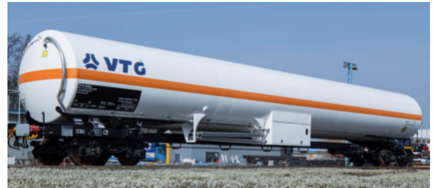
LNG Tank wagon
