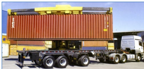
Figura 10 – Conjunto Cavalo Trator com Semirreboque Porta-contêiner e Contêiner de 40' (Fonte: GUIADOTRC).
