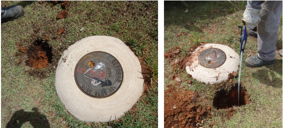
Foto 1. Localização da ST-22. Nota-se que para a coleta de solo foi utilizada uma trena de medição da profundidade.
