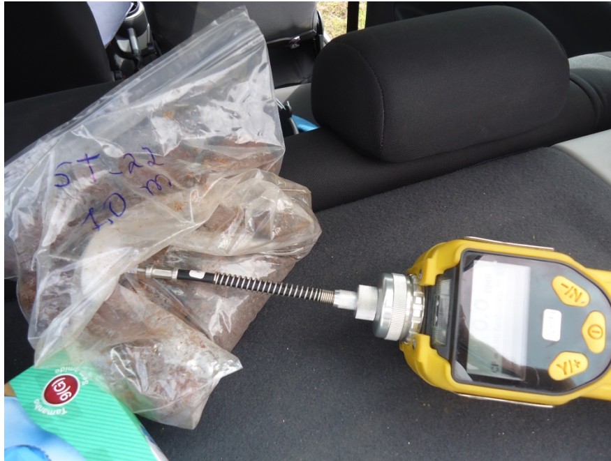
Foto 3. Medição de vapores orgânicos in situ
