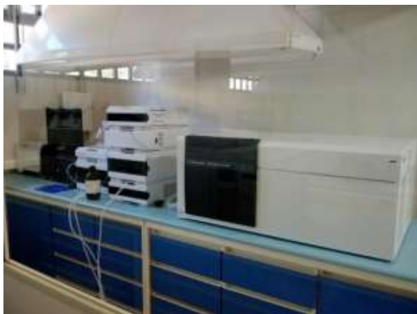
Figura 10. Cromatógrafo em fase líquida de ultra alta eficiência com analisador de massas do tipo triplo quadrupolo (UHPLC/MS-MS)
