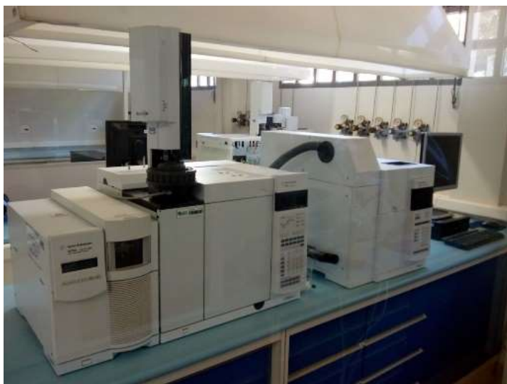
Figura 9. Cromatógrafo em fase gasosa com analisador de massas (GC-MS)
